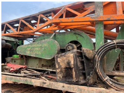
รูปที่ 32 ติดตั้งตะแกรงหรือที่ครอบปิดคลุมส่วนหมุนระบบส่งถ่ายกำลังป้องกันอุบัติเหตุของคณงาน
