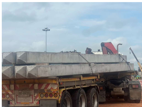
รูปที่ 2 การผูกมัดวัสดุบริเวณรถบรรทุก
